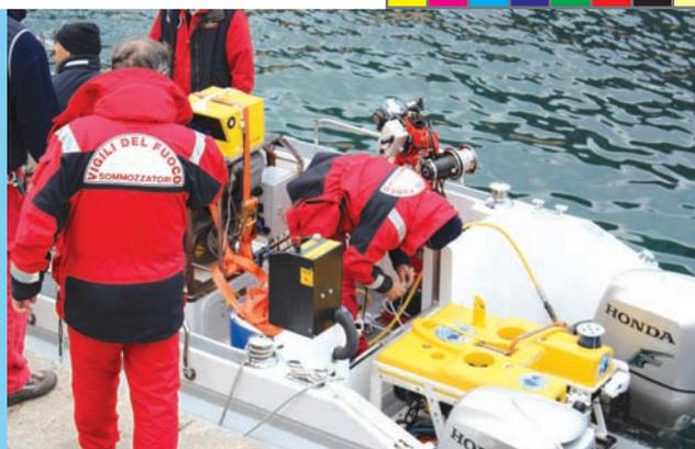
**Tra i mezzi subacquei d'ogni tipo impiegati nelle ricerche e soccorsi ecco anche il Perseo, uno dei Rov - remote operative vehicle in uso ai Vigili del Fuoco, mentre viene allestito a poppa del gommone appoggio**
